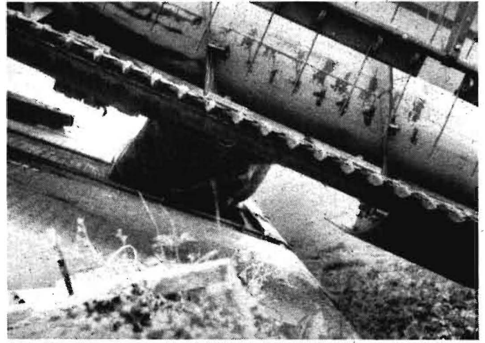
Bild 4. Prüfstand Lauterbach: Reifendeformation am talseitigen Rad eines Mähreschers (Fotos: W. Kahlenbach 2, H. Beck 2)
