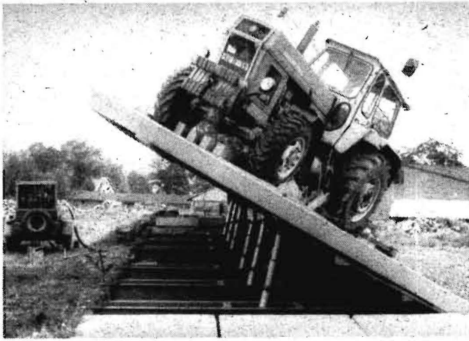
Bild 3. Prüfstand Lauterbach: Zugtraktor-ZT 303 in Schichtlinie auf der Drehplattform
