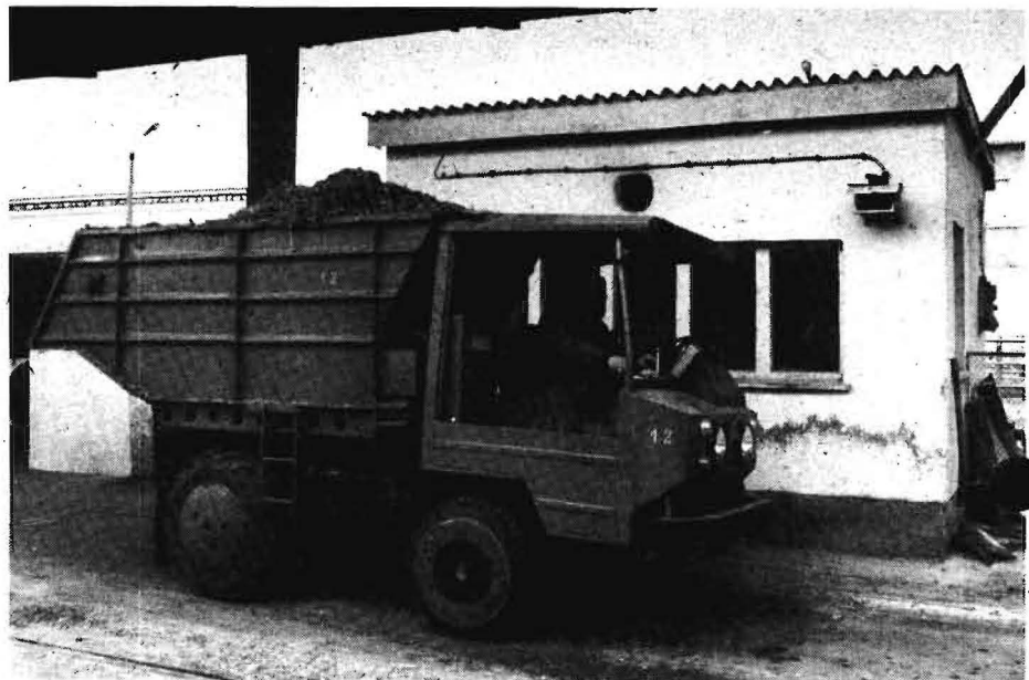
Bild 1. Straßenfahrzeugwaage mit Großsichtanzeige für das Wägeregebnis
