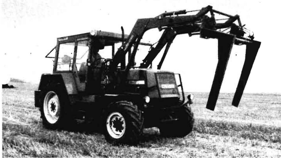
Bild 2. ZT 323/ND5-050 mit Werkzeug für den Quadergroßballenumschlag
