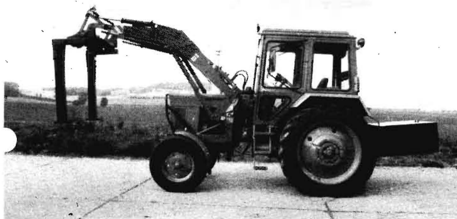
Bild 3. MTS-550/ND5-018M mit Werkzeug zum Quadergroßballenumschlag (max. Hubhöhe 3520 mm, Reichweite 1050 mm, Hubkraft 15 kN)
