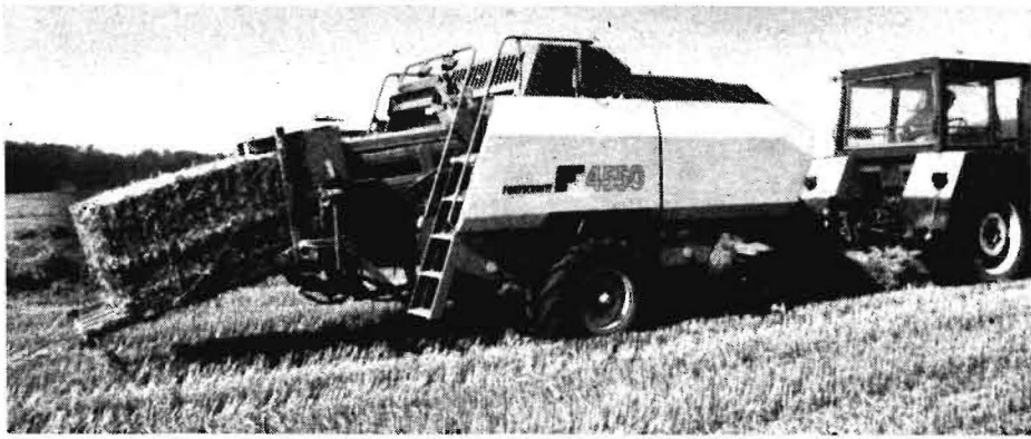
Bild 1. Quadergroßballenpresse (Prinzipmuster) aus dem VEB Erntemaschinen Neustadt
