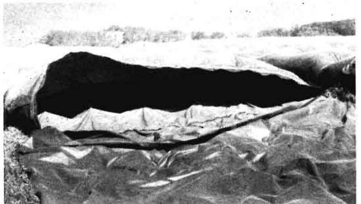
Bild 4. Innenansicht eines am oberen Haftbandschluß geöffneten Kollektorsegments; oben: von der Sonne bestrahlter schwarzer Absorber Mitte: sechs Zugbänder unten: von den Zugbändern angehobene Kollektorseite Vordergrund: auf der Erde liegendes abgetrenntes Kollektorsegment rechts: in Betrieb befindlicher Kollektor
