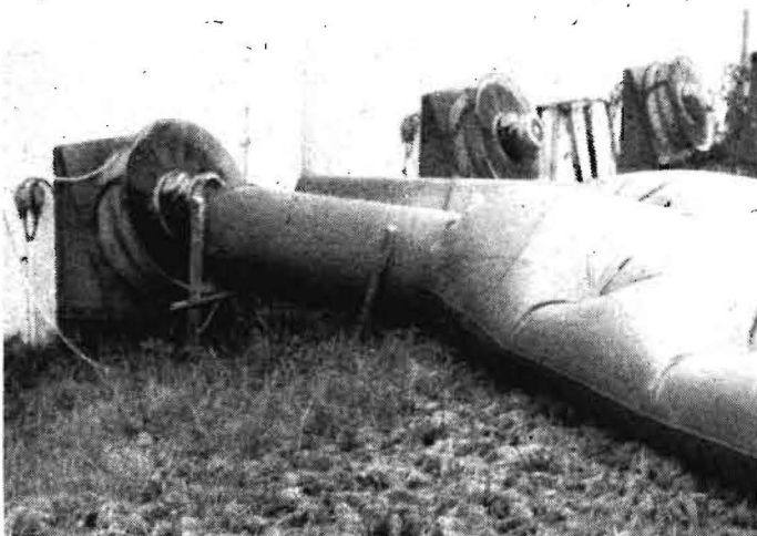
Bild 3. Übergabe der Warmluft an den Ventilator der Belüftungsanlage durch Gebläserohre
