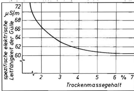
Bild 4. Spezifische elektrische Leitfähigkeit der Schweinegülle in Abhängigkeit vom Trockenmassegehalt
