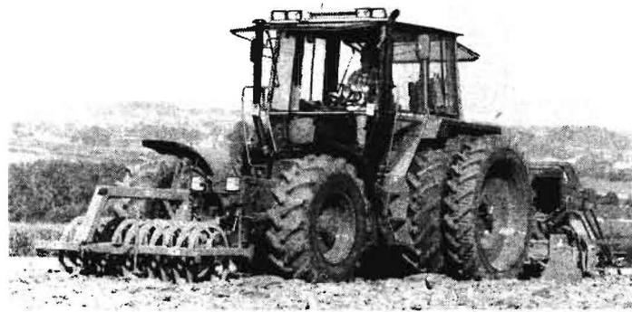
Bild 2. Geräteträger F390GTA (74 kW) mit Doppelbereifung an der Hinterachse und angebaute Bestellgerätekombination (Werkfoto)
