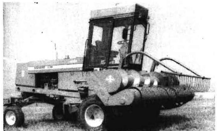
Bild 1. Breitschwadlüfter als Adapter am Schwadmäher (Werkfoto)
