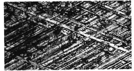
Bild 5. Honriefenorientierung mit gleichmäßigem Kreuzschliff und einem Honwinkel von rd. 50° (Querschliff 100:1)
