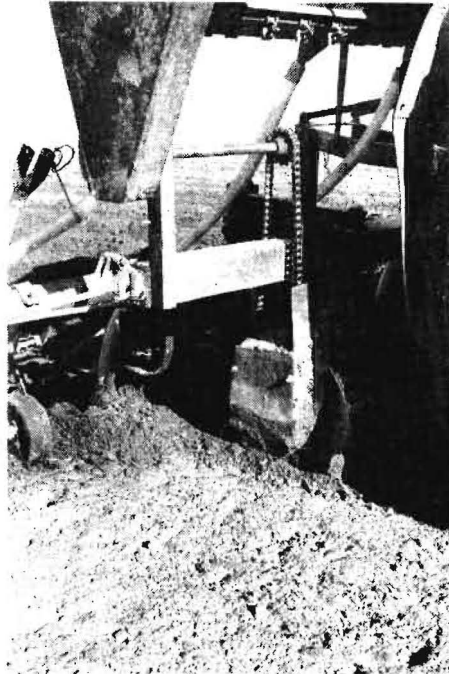
Bild 4. Antrieb der Düngungseinrichtung über Bodenrad und Rollenkette
