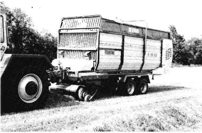
Bild 3. Lade- und Dosierwagen Titan 6/36 GD bei der Aufnahme von Welkgut für die Silierung
