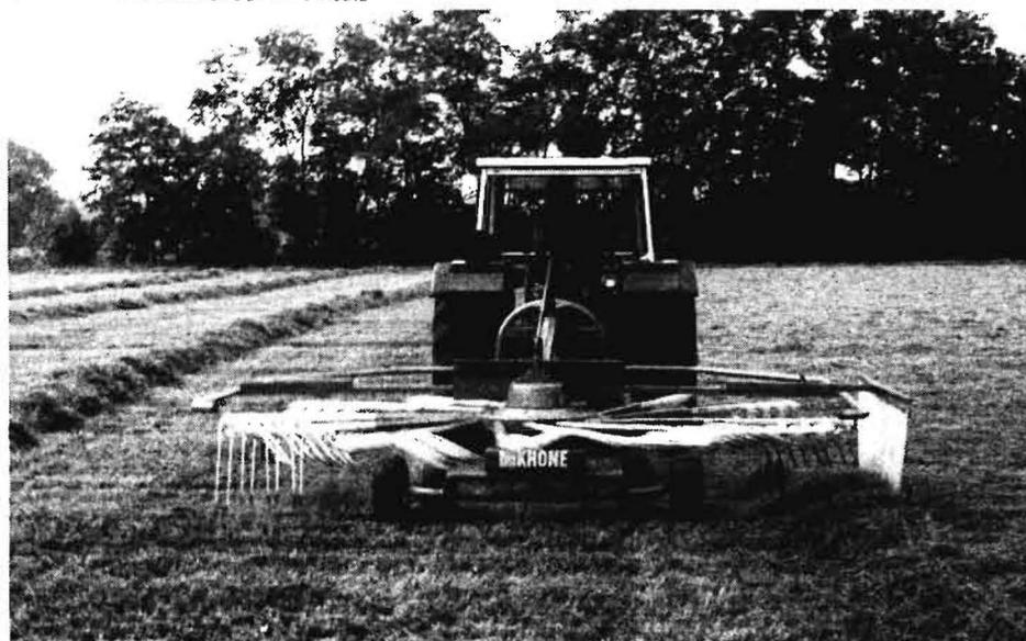
Bild 2. Kreiselschwader mit Parallelpendelachse
