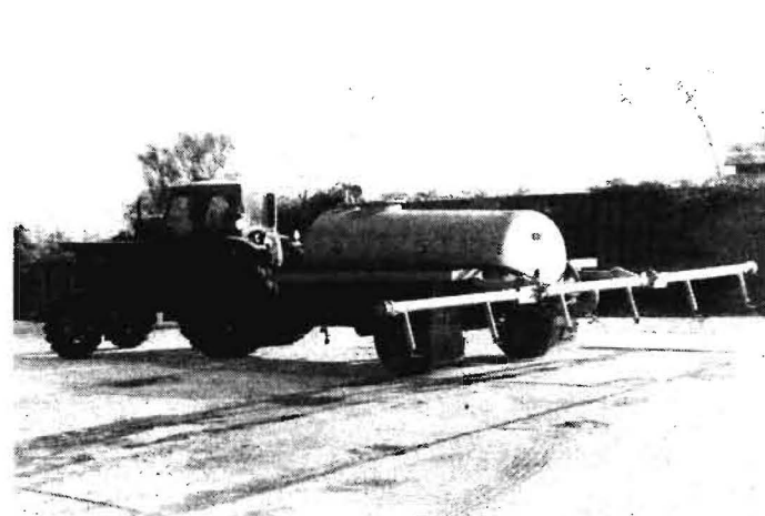
Bild 1. Für Feldversuchszwecke des Forschungszentrums für Bodenfruchtbarkeit Müncheberg, Bereich Bad Lauchstädt, gefertigte Gülleverteileinrichtung in Arbeitsstellung
