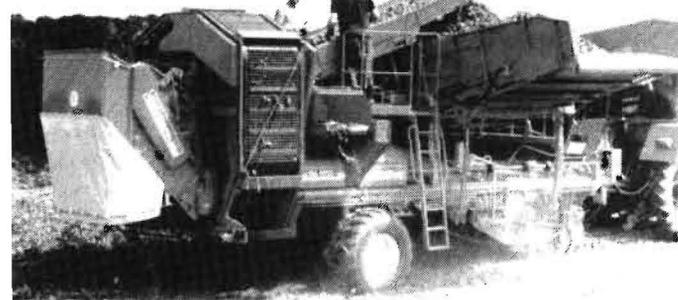
das Erntegut von vier Reihen aufgenommen und in einem Schwaden abgelegt werden. Die Dammaufnahme besteht aus 4 Spatenscharen, 4 Dammtrommeln, 8 gezogenen federnden Sechsscheiben und 5 Krauteinzugrollen. Die Siebbänder werden hydraulisch angetrieben.
