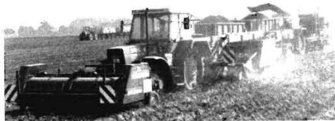
Bild 4. Zweireihiger Rodelader DL 1500 mit Verlesestand; in Arbeitsstellung Länge 8,65 m, Breite 5,5 m, Höhe 3,3 m, Spurweite 3,0 m, Masse 4550 kg, Leistungsbedarf 40 kW
