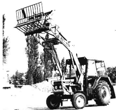
Bild 3 Schaufel mit schwenkbarem Boden an der Stallarbeitsmaschine HT 140 beim Dungstapeln
