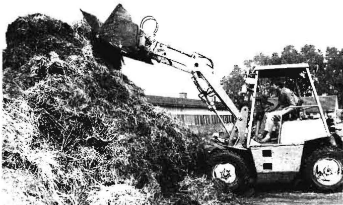
Bild 3 Schaufel mit schwenkbarem Boden an der Stallarbeitsmaschine HT 140 beim Dungstapeln
