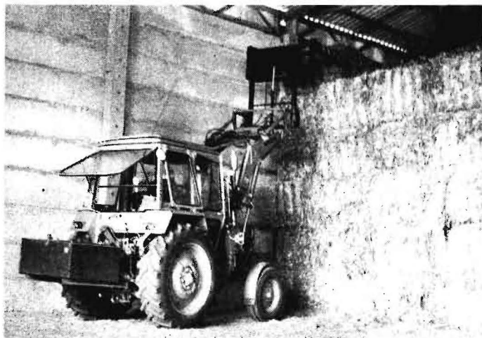
Bild 6. Stapeln von Quadergroßballen mit Traktor MTS-550 und Frontlader ND 5-018 sowie angebauter Ballenklammer mit Huberhöhung (Fotos: G. Kotte)
