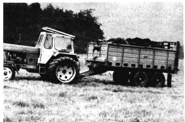
Bild 1. Spezialanhänger T 088 mit Breitstreuereinrichtung D 353
