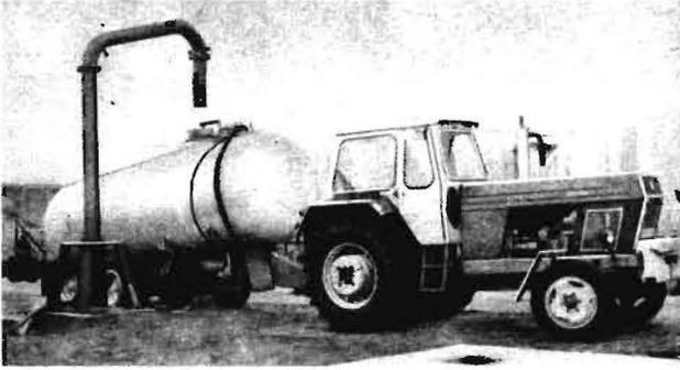
Bild 2. Tankfahrzeug HTS 100.27 (10 t) und Güllegeber LTP
