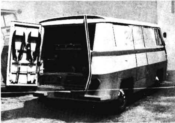
Bild 3. Pflegefahrzeug TV 41-F mit pneumatisch betriebener Ausrüstung
