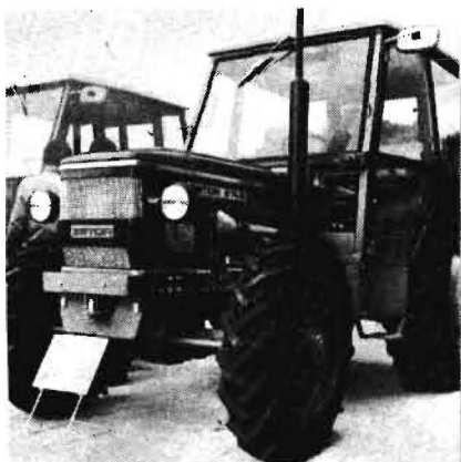
Bild 1. Der Radtraktor Zetor 5745 gehört zur I. einheitlichen Zetor-Traktorenreihe. Er hat eine zusätzlich angetriebene Vorderachse, die besonders unter schwierigen Bedingungen Anwendung findet
