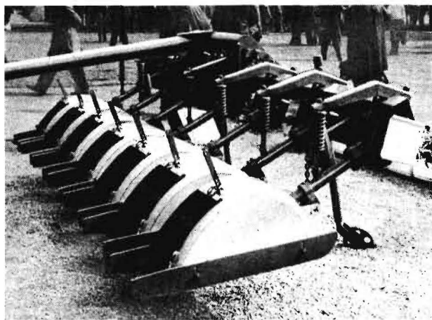
Bild 3. Das sechsheilige Vereinzelnungsgerät für Zuckerrüben 6 JECZ
