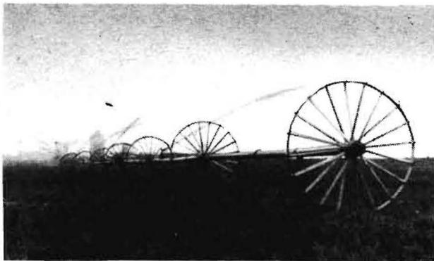
Bild 1. Rollbare Regnerleitung RR 175/600 beim Verregnen von Gülle
