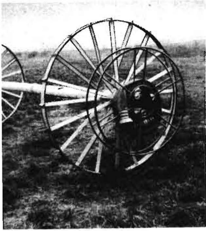
Bild 3 Schlauchhaspel zum Transport der An- schlußschläuche an der RR 175/600
