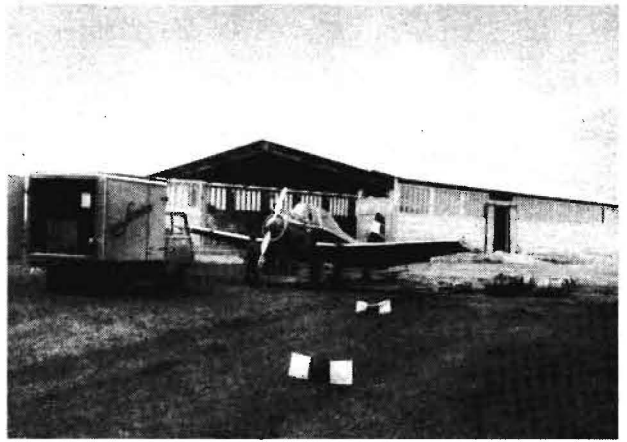
Bild 1. Zur operativen Schadensbeseitigung an Agrarflugzeugen werden Service-Wagen eingesetzt, die mit den notwendigen Ausrüstungen und Materialien versehen sind
