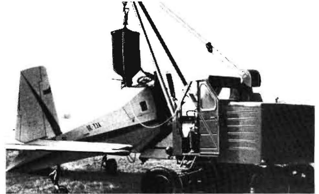
Bild 4 Beladen einer Z-37 mit Mineral- dünger
