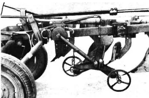
Bild 1. Meßwertaufnehmer und Meßwandler zur Arbeitstiefenmessung
