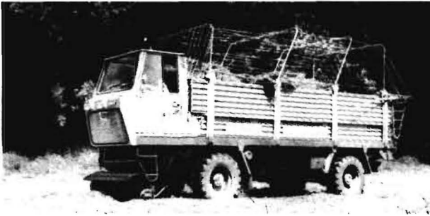
Bild 1. Selbstfahrender Universaltransporter „Agrobil S“ von Fendt (BRD)
