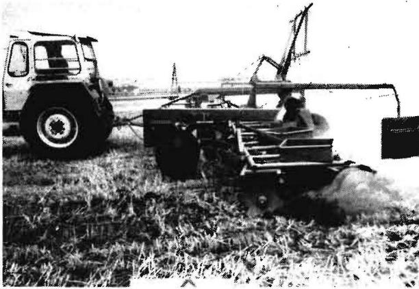
Bild 17. Kopplungswagen T 890 mit 4 Scheibeneggen B 492 hinter ZT 300, bei den herrschenden Bodenbedingungen war die erforderliche Arbeitstiefe infolge noch fehlender Zusatzbelastung der Scheiben nicht ausreichend
