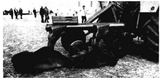
Bild 6. 2furchiger Wettbewerbspflug PN-2-30 (CSSR); lange, auf gute Wendung ausgelegte Streichblechform mit in allen Ebenen verstellbarer großer Streichschiene, zusätzlichen Ballastmassen und rollender Anlage, Scheibensech mit kombiniertem Vorschäler, Stützrad stufenlos seitlich verschiebbar
