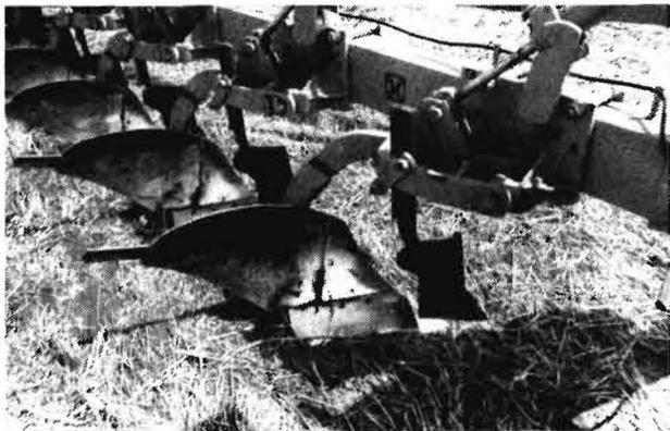
Bild 5. B 501 mit verbessertem Streichblech 30 ZS und am Steinsicherungsgrindel angeklammertem Vorschäler
