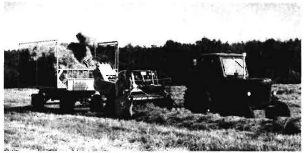
Bild 4. Die Hochdruckpresse K 442/1 mit Ballenwerfer ist die geeignete Maschine für die Preßgutlinie
