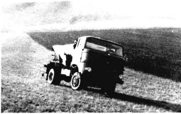
Bild 6. W 50 LAK mit Aufsatzdüngestreuer D 032 bei der Streuarbeit in Schichtlinie (25 Prozent HN)
