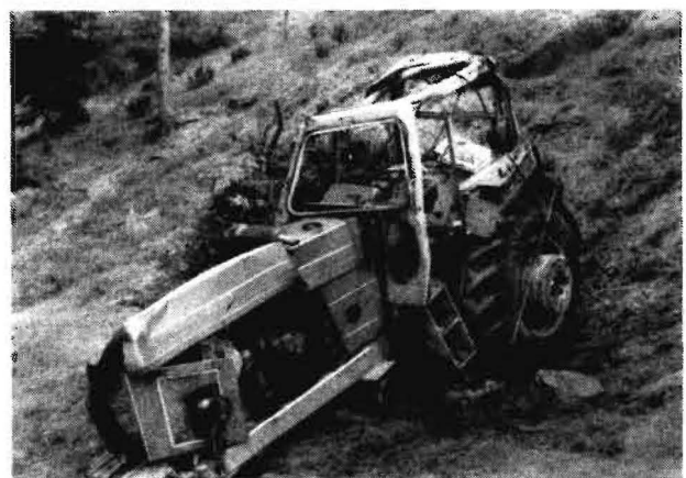
Bild 5. Die umsturz sichere Kabine des ZT 300 hat sich bei diesem Unfall einmal mehr bewährt; die größte Deformation an der Kabine des aufgerichteten ZT 300 betrug 32 cm
