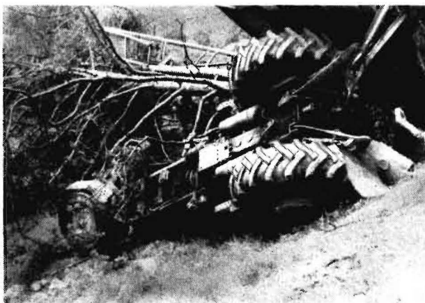
Bild 4. Traktor ZT 300 und Anhänger HW 80.11 mit SHA 8 nach dem Umsturz mit dreifachem Überrollen; der Traktorist hatte nur Ahschürfungen
