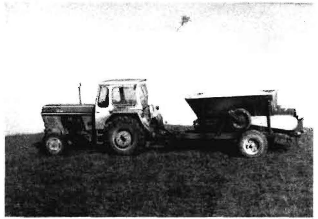
Bild 7. Forschungsmuster eines Aufsattelstreuers (D 029) am Traktor ZT 300 bei der Arbeit an der Einsatzgrenze (30 Prozent HN)
