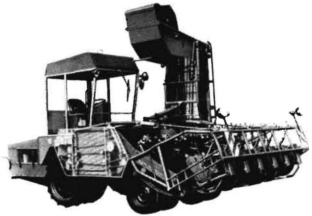
Bild 1. Der sechsreihige selbstfahrende Köpflader 6-OCS in der Transportstellung, der Ladeförderer ist senkrecht hochgeklappt
