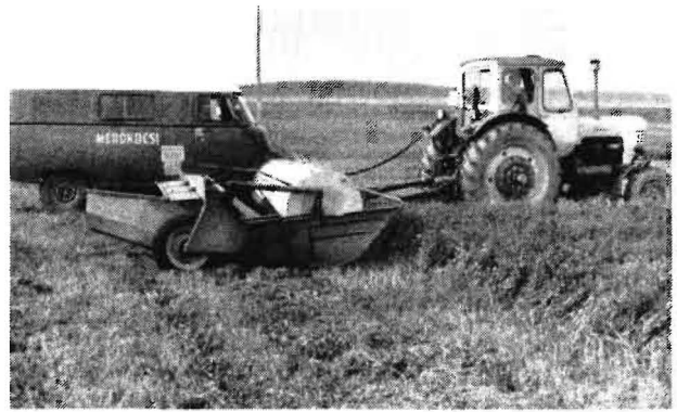
Bild 2. Energetische Messungen der Kombination Schwadmäher-Stengelknickereinrichtung für die Ernte von Luzerne
