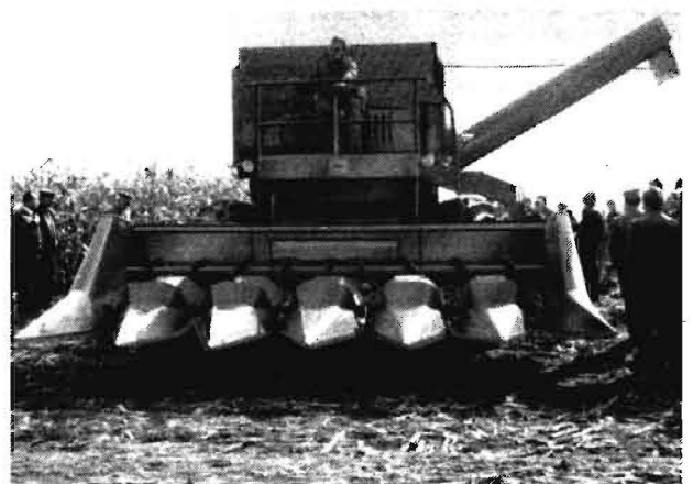
Bild 3. John Deere 970 Mäh-drescher mit Maispflückvorsatz John Deere 543
