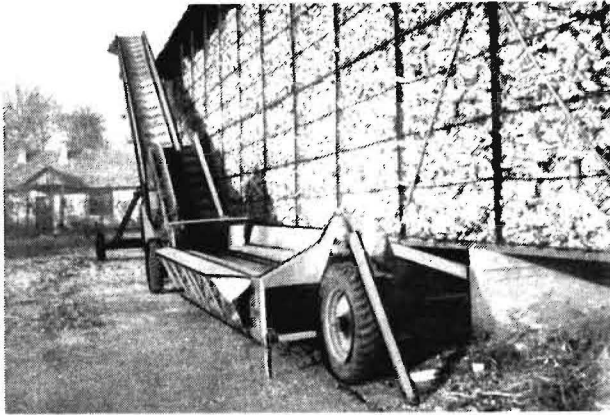
Bild 2. Mobiler Annahmetisch MG mit Allesförderer T 223
