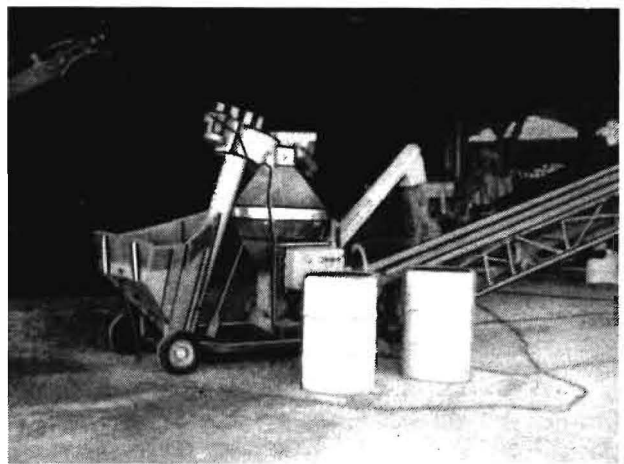
Bild 5. Konservierungsmaschine Propitox-30: Hauptabmessungen 3280 mm × 1290 mm × 2275 mm, Leistung des eingebauten Elektromotors 4,0 kW, Nennleistung 30 t/h, Hersteller: Budapestster Landmaschinenfabrik, Ungarn
