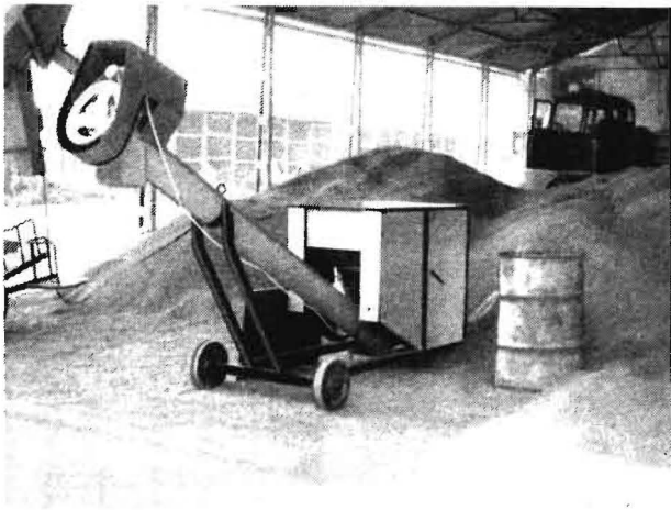
Bild 4. Konservierungsmaschine Propimob-10: Hauptabmessungen 3600 mm × 1100 mm × 2000 mm, Leistung des eingebauten Elektromotors 1,1 kW, Nennleistung 10 t/h, Hersteller: M. G. V. Veszprém, Ungarn
