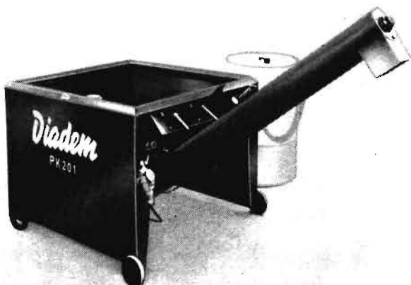
Bild 2. Diadem PK-201: Hauptabmessungen 2500 mm × 1250 mm × 1250 mm, Leistung des eingebauten Elektromotors 2,5 kW, Nennleistung 20 t/h, Hersteller: H. W. Dreyer, Essen
