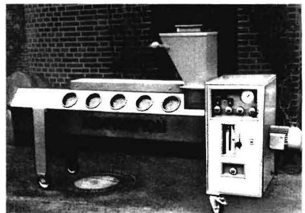
Bild 3. Naßkorn-Konservator: Hauptabmessungen 2700 mm × 700 mm × 1100 mm, Leistung des eingebauten Elektromotors 3,3 kW, Nennleistung 30 t/h, Hersteller: AHI-Werke, Itzehoe
