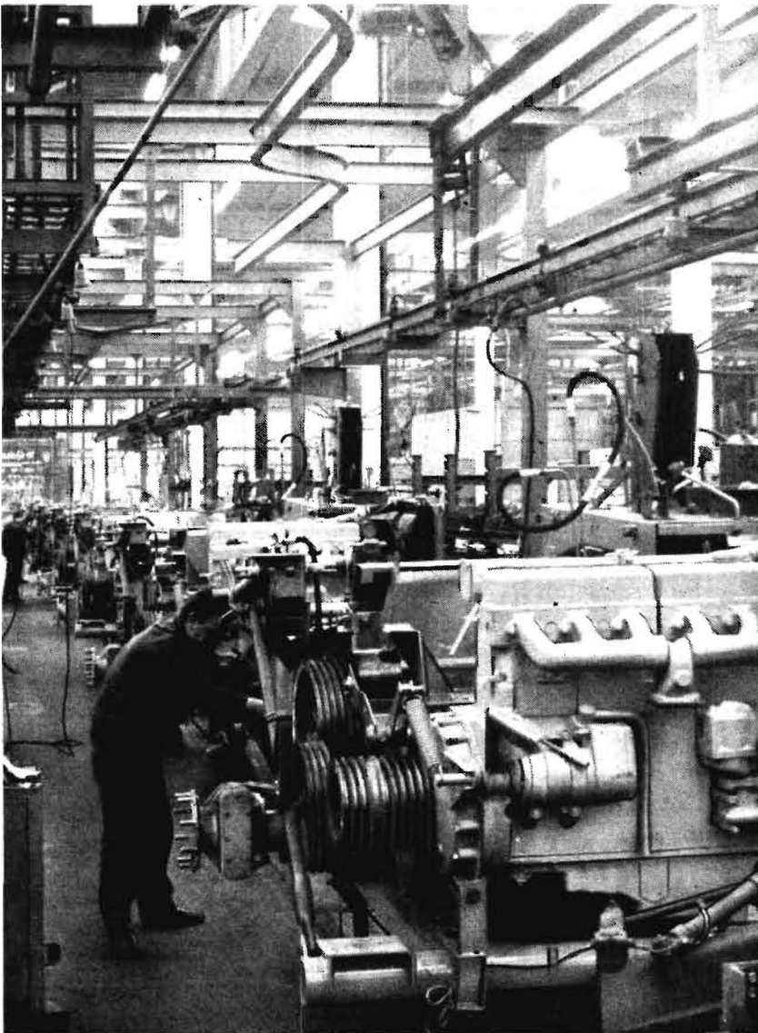
Bild 1. Montage des Grundgeräts E 285 auf der Wechselfließreihe im VEB Traktorenwerk Schönebeck, Betrieb II im Kombinat Fortschritt. (Foto: E. Weitzmann)
