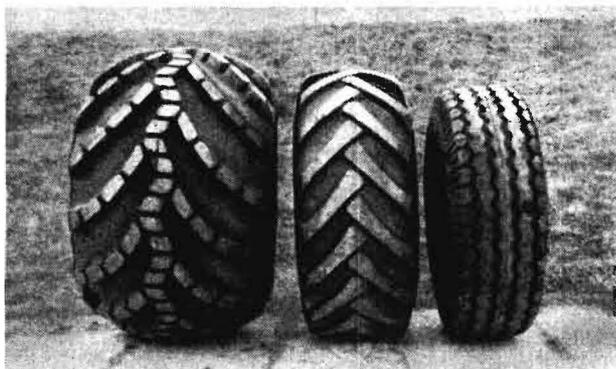
Bild 3. Niederdruckreifen für Transportfahrzeuge: von rechts nach links: 12,5-20, 16-20, 1140-600
