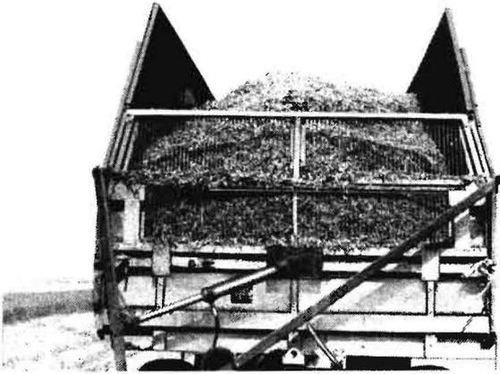
Bild 2. Der von einem Neuererkollektiv des KfL Köthen, Sitz Ahrensdorf durchsichtiger gestaltete Anhänger HW 80.11 kann auch mit Schwerhäckselaufbauten gekoppelt eingesetzt werden
