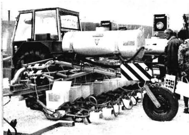
Bild 4. Die zwölfreihige Universalmaschine 12-Se PUZ für die Gleichstandsart von Zuckerrüben und anderen Früchten mit dem Zusatz-Bandspritzgerät für Herbizide
