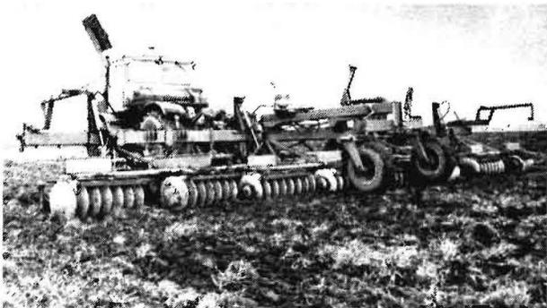
Bild 1. T 890 mit eingebauten Scheibeneggen B 492 bei der Stoppelbearbeitung. Durch eine hydraulische Zusatzeinrichtung kann das Gewicht des Koplungswagens weitgehend auf die Scheibeneggen verlagert werden, wodurch sich die hinteren Stützräder des T 890 ausheben (Foto: Domsch)
