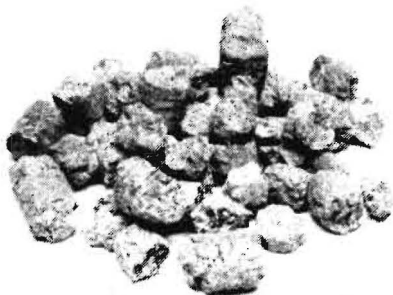
Bild 1. Auf einer Kollermatrizenpresse erzeugte Formlinge, Lagerungszeit rund 1 Jahr
