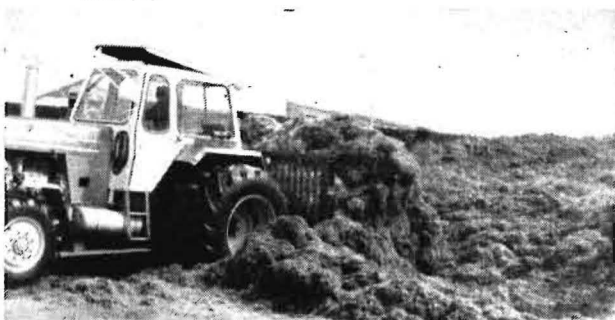
Bild 1. Heckgabel am ZT 300 zur Verteilung des Silierguts im Horizontalsilo
