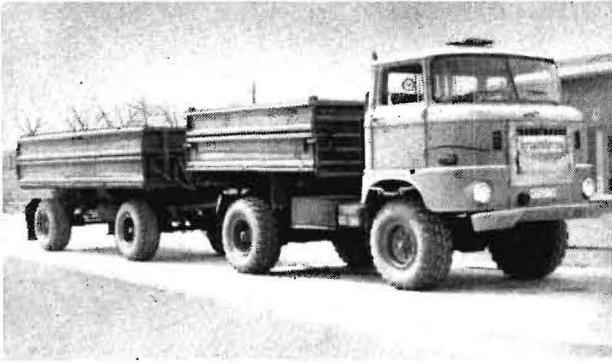
Bild 1. Fahrbares Meßfahrzeug W 50 LA/Z mit Anhänger HW 80.11
