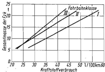
Bild 3. Kraftstoffverbrauch in l/100 km in Abhängigkeit von der Gesamtmasse in t der Fahrzeugkombination (Fzk) nach Fahrbahnklassen
