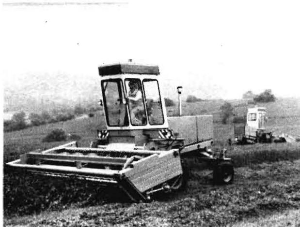
Bild 1. Schwadmäher E 301, ausgestattet mit dem sowjetischen Motor D-50
