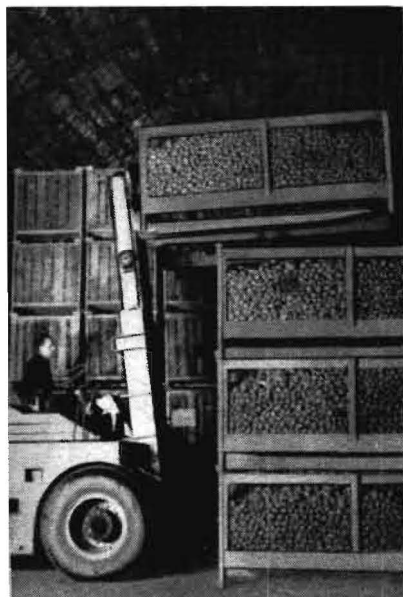
Bild 2 Gabelstapler DFG 6302 beim Einstapeln des Großbehälters
