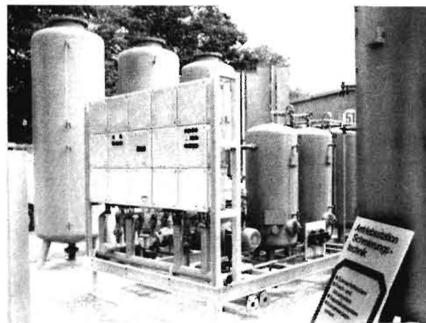
Bild 2. Durch die industrielle Vormontage der Antriebsstation für die komplette Schmierungsanlage wird deren Aufbau wesentlich erleichtert und beschleunigt
