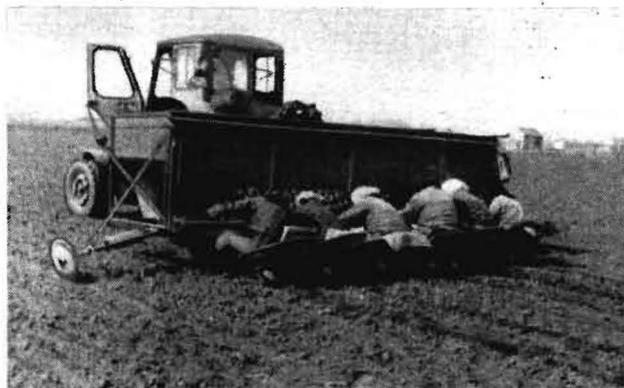
Bild 6. Als Ergebnis betrieblicher und überbetrieblicher Neuererarbeit entstand diese Stecklingspflanzmaschine
