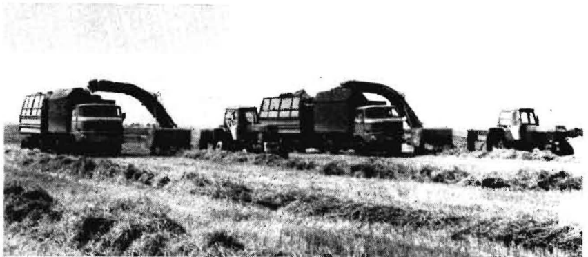
Bild 1. Die Parallelbeladung der Anhänger begünstigt den Komplexeinsatz der Hochdruckpressen
