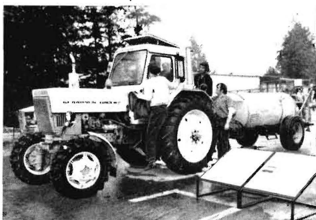
Bild 2. Traktor Belarus MTS-82, die Variante dieses zukunftssträchtigen Traktors mit zusätzlichem Vorderradantrieb
