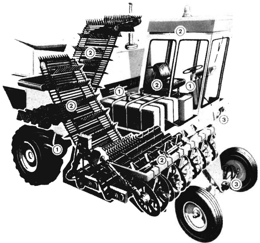
Bild 1 Kooperation bei der Entwicklung und Fertigung des selbstfahrenden sechsstufigen Rübenrodeladers KS-6
