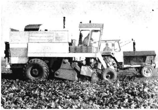
Bild 3. Rübenrodelader KS-6 im Einsatz
