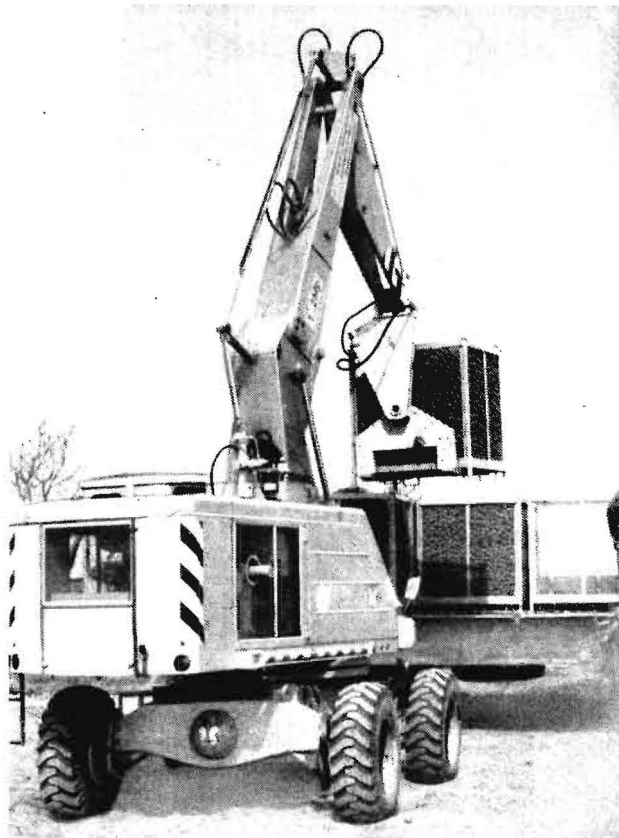
Bild 2. Umschlag von Kartoffelpaletten mit Mobilkran T 174 mit dem speziellen Anschlagmittel „Meißen“
