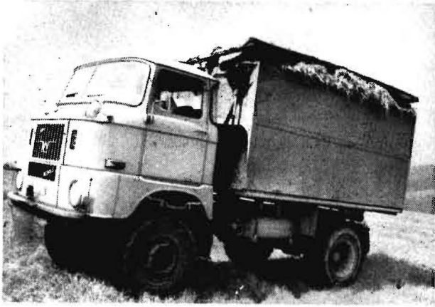
Bild 2. Abgesenkter Überblasschutz unmittelbar nach der Beladung
