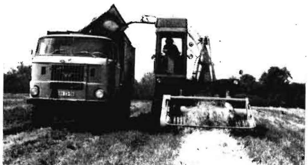
Bild 5. Bei der gleichen Arbeit werden durch die neue Kombination Überblasschutz-Laderaumabdeckung Verluste fast vollkommen vermieden
