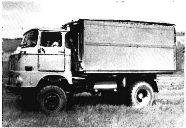
Bild 3. Nach einer kürzeren Fahrstrecke hat sich der Überblasschutz soweit abgesenkt, daß er als Laderaumabdeckung wirksam wird
