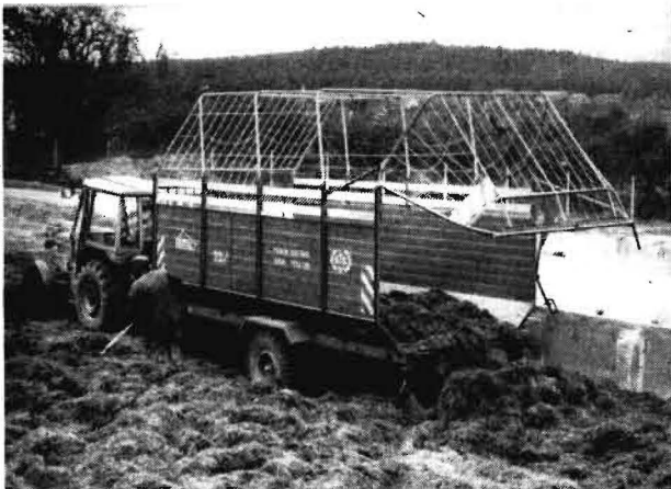
Bild 5. Das Gut wird aus dem HORAL 33 Aktiv in ein Horizontalsilo entladen
