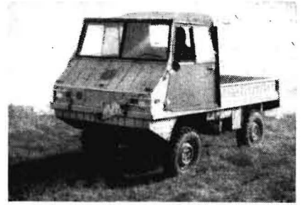
Bild 3. Steyr-Puch „Hafflinger“ 700 AP (Allradantrieb, Motorleistung 27 PS \approx 20 kW, Nutzmasse 0,5 t, Treibstoffverbrauch 9 bis 12 l/100 km, Höchstgeschwindigkeit 75 km \cdot h -1 )
