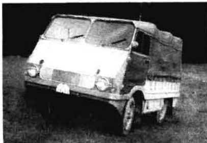
Bild 4. Skoda-CZ 998 (Allradantrieb, Motorleistung 47 PS \approx 35 kW, Nutzmasse 0,8 t, Treibstoffverbrauch 11 bis 13 l/100 km, Höchstgeschwindigkeit 80 km \cdot h -1 )
