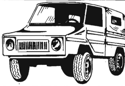
Bild 2. Saporoshez SAS 969 V „Wolynjanka“ (Allradantrieb, Motorleistung 30 PS \approx 22 kW, Nutzmasse, 0,4 t, Treibstoffverbrauch \approx 9 l/100 km, Höchstgeschwindigkeit 75 km \cdot h -1 )
