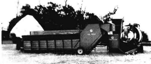
▲ Bild 1. Trocknungsanlage TU-22 bei der Arbeit; im Vordergrund der Dosierer
