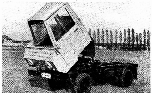
Bild 2. Grundtyp M 24 00 mit angekipptem Fahrerhaus
